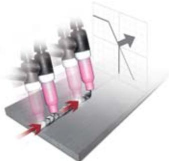
Consente l'immediato spegnimento dell'arco durante la rampa di discesa o la ripartenza del ciclo di saldatura.
